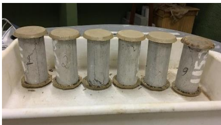
Figura 11 – Corpos de prova após rompimento Fonte: Próprio Autor (2019)
