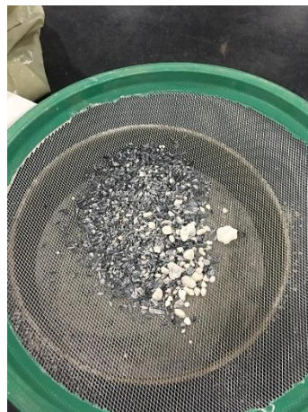
Figura 3 – Cinza da madeira de eucalipto (CME) Fonte: Próprio Autor (2019).
