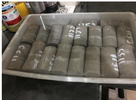
Figura 13 – Corpos de prova submersos para pesagem após 24hr, 48hr, 72hr. Fonte: Próprio Autor (2019)
