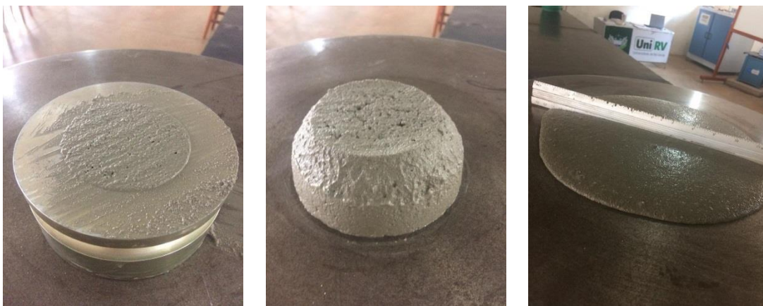
Figura 16 – Ensaio do índice de consistência Fonte: Próprio Autor (2019)
