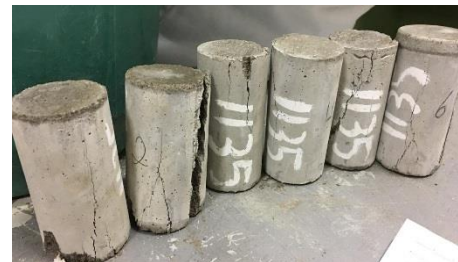
Figura 11 – Corpos de prova após rompimento Fonte: Próprio Autor (2019)
