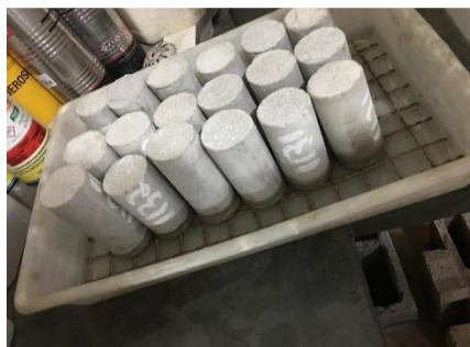
Figura 14 – Corpos de prova com cinco milímetros de água para pesagem após 3hr, 6hr, 24hr, 48hr e 72hr. Fonte: Próprio Autor (2019)
