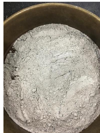
Figura 3 – Cinza da madeira de eucalipto (CME) Fonte: Próprio Autor (2019).
