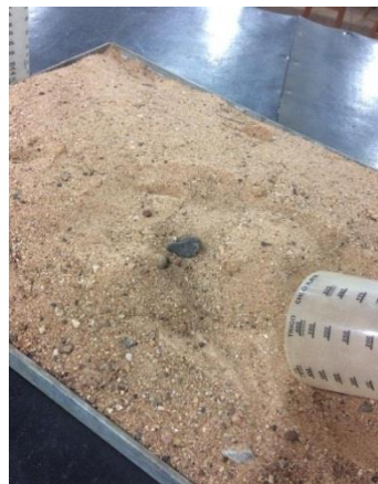
Figura 4 – Areia fornecida pela faculdade e submetida ao ensaio de granulometria. Fonte: Próprio Autor (2019).
